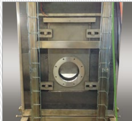
Beam Shutter motorisé avec chambre sous vide - CNRS – Paris
