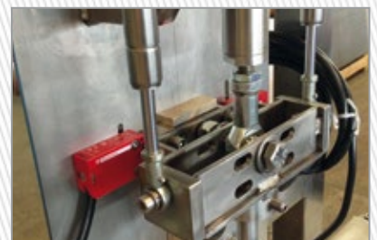
Beam Shutter motorisé avec chambre sous vide - CNRS – Paris
